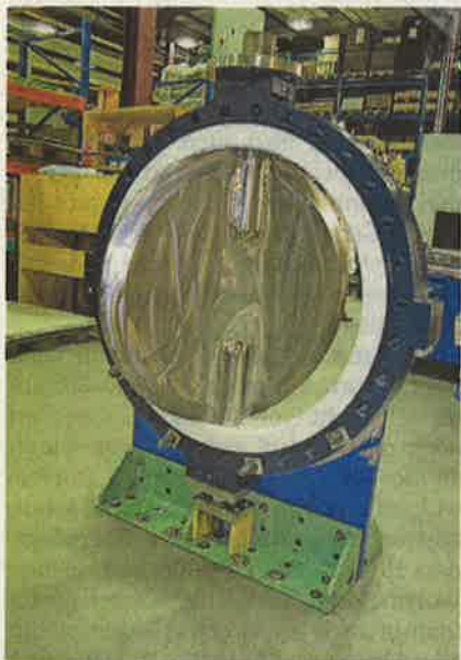
Dieses Ventil hat einen Innendurchmesser von 90 Zentimeter.
